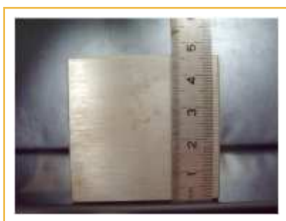
Fig. 2: Coincidencia del borde la regla con el de la pieza.
