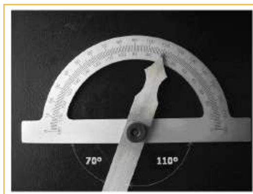
Fig. 36: Ángulos suplementarios medidos por un transportador.
