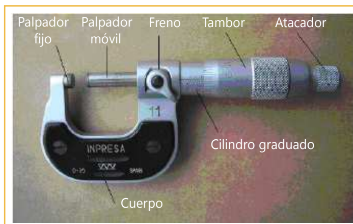
Fig. 28: Micrómetro de exteriores y sus partes.
