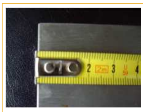
Fig. 8: El gancho se desliza para facilitar la coincidencia del cero con el borde de la pieza.
