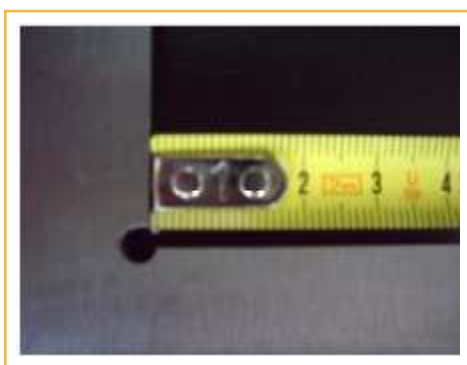
Fig. 8: El gancho se desliza para facilitar la coincidencia del cero con el borde de la pieza.
