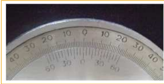
Fig. 39. Detalle del nonio de un goniómetro de apreciación 5'.
