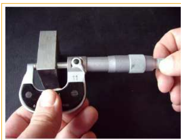
Fig. 34: Medición con micrómetro. Observa cómo la mano derecha actúa sobre el atacador.
