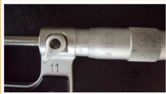
Fig. 31. Micrómetro efectuando una medida de 3,20 mm.
