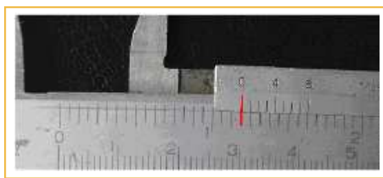
Fig. 42: Calibre efectuando una medida de 1\frac{1}{16}'' .
