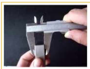
Fig. 23: Forma de sujetar el calibre para medir.
