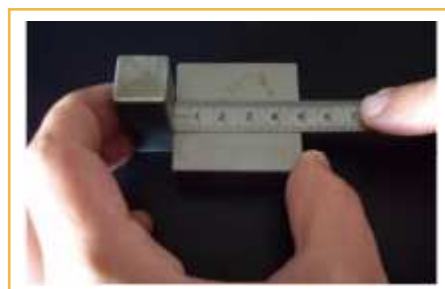
Fig. 3: Utilización de un tope para facilitar la coincidencia del cero de la regla con el borde de la pieza.
