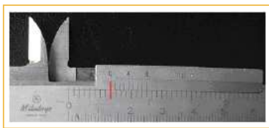
Fig. 41. Calibre efectuando una medida de 1/2'' .
