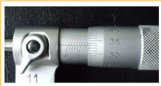
Fig. 32: Ejemplo de medición.
