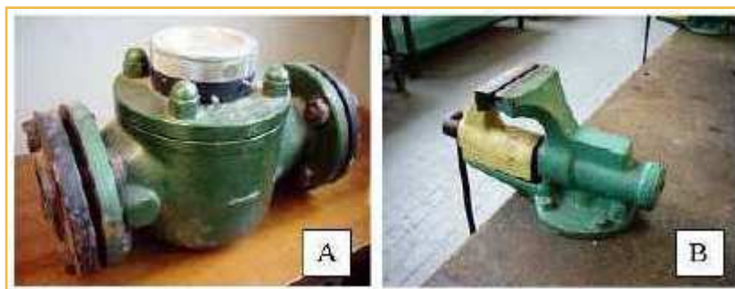
Fig. 24: A) Contador de agua con cuerpo de fundición. B) Tornillo de banco fabricado en fundición.
