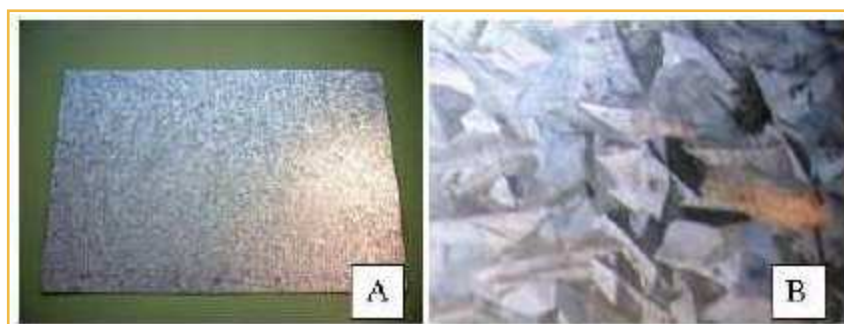
Fig. 33: A) Chapa de acero galvanizado.
