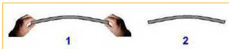
Fig. 12: Comportamiento de un material plástico tras haber sido deformado.
