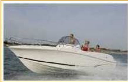
Fig. 53: Casco de embarcación de fibra de vidrio y resina de poliéster.
