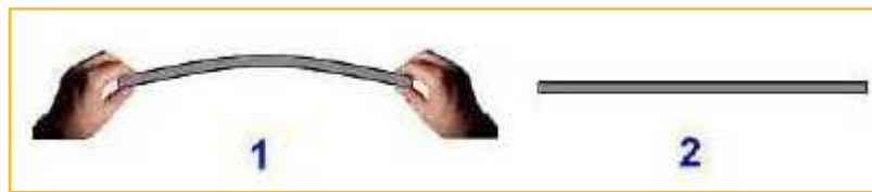
Fig. 11: Comportamiento de un material elástico tras haber sido deformado.
