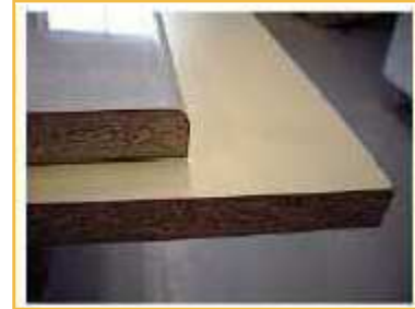
Fig. 52: El tablero superior recubierto de resina úrica, el inferior de resina melamínica.
