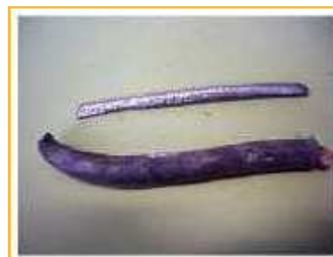
Fig. 31: Fragmentos de plomo con distintos grados de oxidación.
