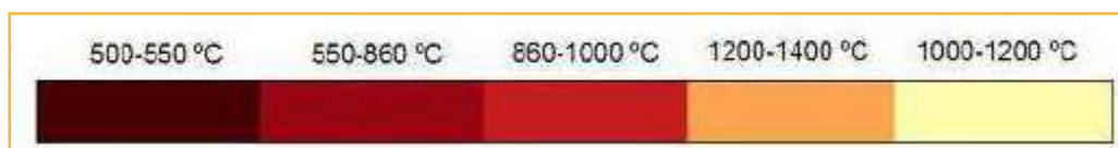
Fig. 41: Relación entre el color y la temperatura del acero.
