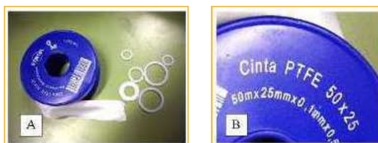
Fig. 50: A) Cinta y juntas de teflón. B) Detalle de las características de la cinta.
