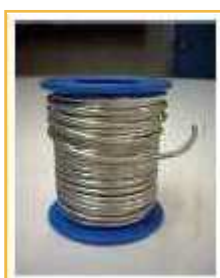
Fig. 32: Rollo de estaño empleado en soldadura blanda.
