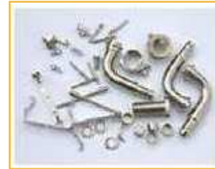
Fig. 39: Diversas piezas recubiertas con baño de níquel.
