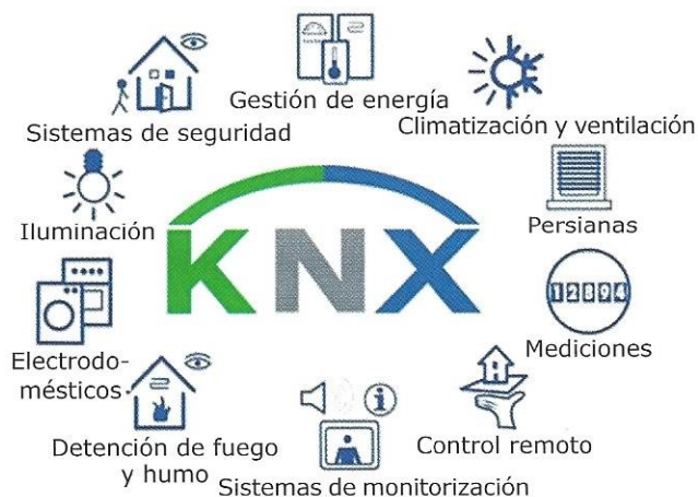
Figura 4.2. Áreas de control del sistema KNX. Fuente: Konnex.
