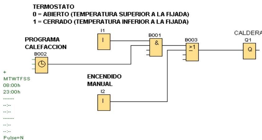
Circuito 2: La calefacción está dividida en dos zonas: Dormitorios y Salón, en cada una de las zonas disponemos de un termostato que controla la temperatura de su correspondiente zona, (I1, I2) desactivando la electroválvula (NC) correspondiente (Q2, Q3), en caso de alcanzar la temperatura deseada. La caldera (Q1) deberá de ponerse en marcha si alguna de las dos zonas demanda calefacción. Se parará cuando alcancemos la temperatura deseada en ambas zonas.
