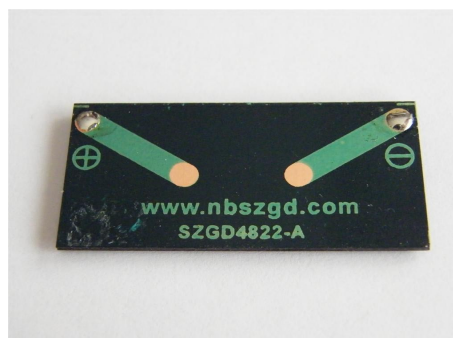
Vista anterior e posterior da célula solar
