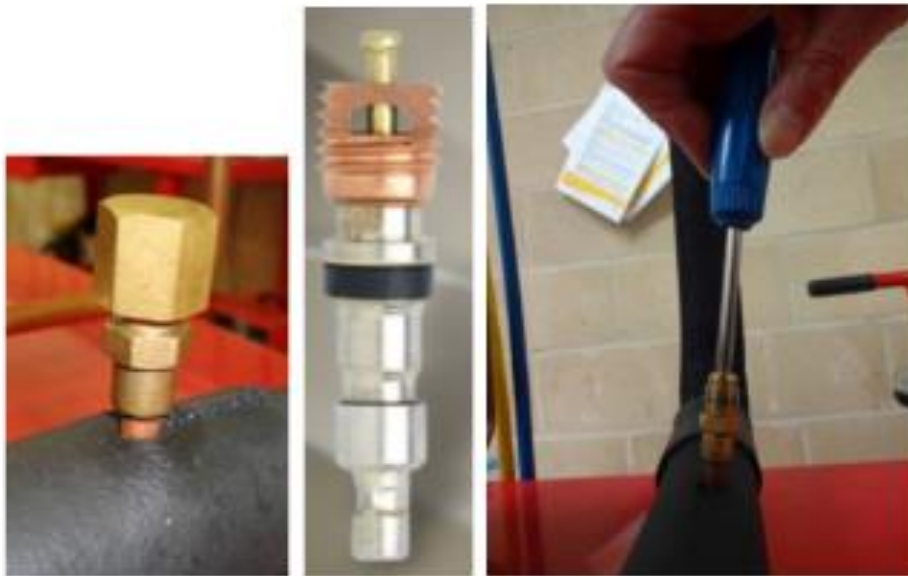
Tuerca hexagonal; Válvula obús; Herramienta especial para apretar obuses
