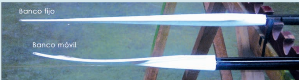
92 / Las palas de los remos según sean de una modalidad o de otra tienen distintos perfiles.
