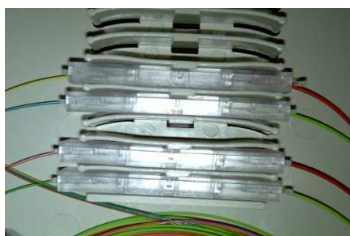
Organización (empalmes mecánicos)
