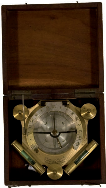
Reloxo de sol equinoccial con compás incorporado do taller de Gaggini et Moissette (1850-1870)
