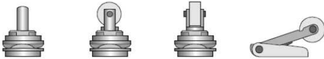
Principais accionamentos mecánicos ( eixes, rodillos, levas )
