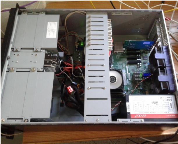
Servidor instalado nunha caixa de 4U para armario RACK.
