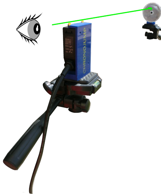
Figura 12.1: Alineación de la fotocélula
