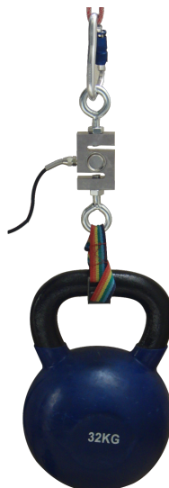
Figura 5.44: Calibración del sensor de fuerza
