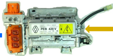
Control del motor/generador eléctrico (PEB Power Electronic Box)
