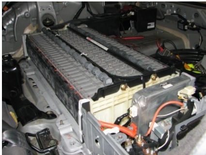
Batería de tracción: 200v Corriente continua
