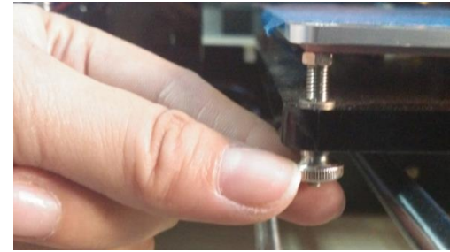
Fig 9: Ajuste de Altura de la Superficie de Impresión
