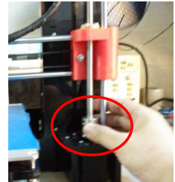
Fig 5: Ajustar Altura del Montante X
