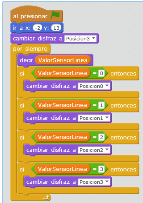
Fig2. Script Simulación del seguidor de línea blanca.
