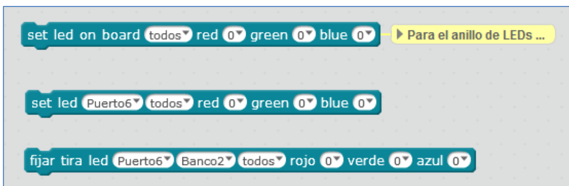
Fig 2: Comandos para diferentes modelos de LEDs
