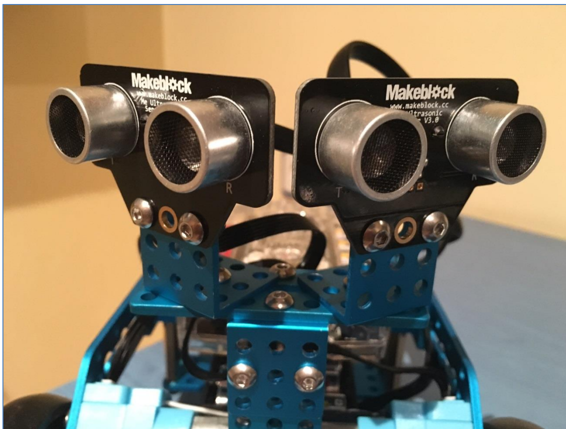
mBot Ranger con 2 sensores de ultrasonidos.
