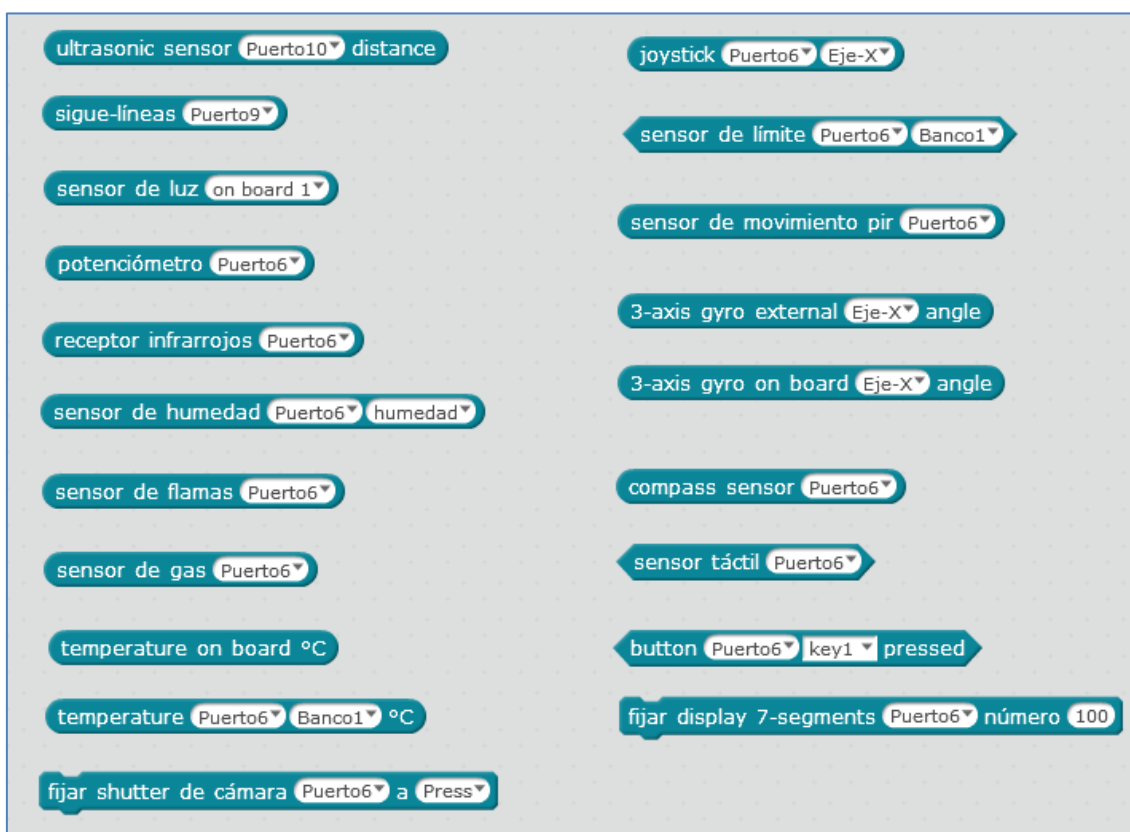
Fig 5: Comandos específicos para multitud de sensores
