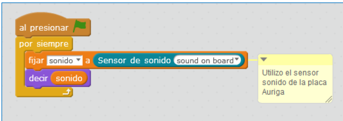
Ejemplo de control del sensor sonido en la placa Me Auriga
