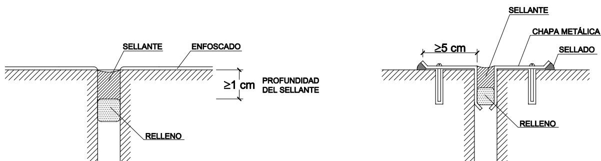
Figura 2.6 Ejemplos de juntas de dilatación
