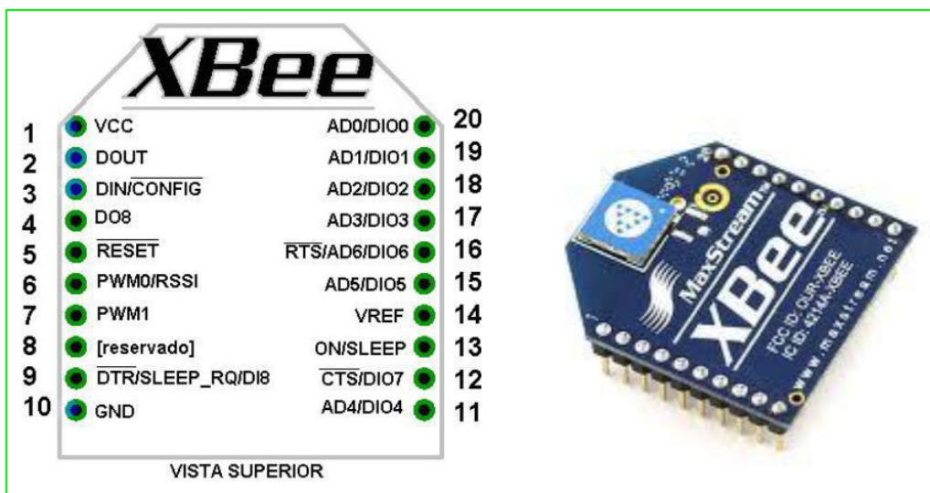
Figura 3-5 .- Aspecto e patillaxe do módulo Xbee
