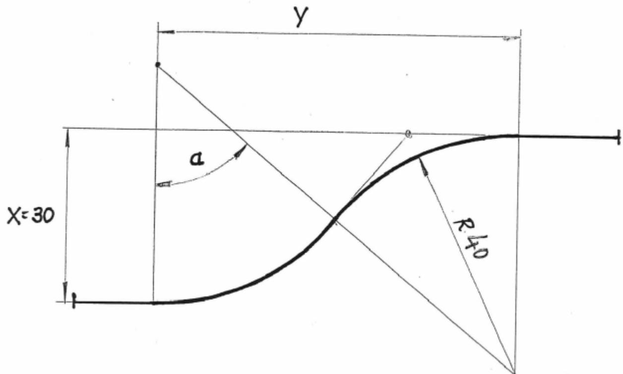
Soluciones: 1.- incógnitas  $Y= 62.4$   $\text{Tg } a/2=25.67^\circ$
