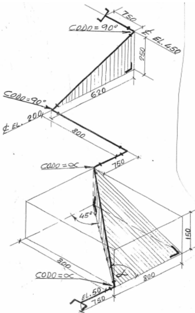
Seguidamente, procederemos a realizar el cálculo y aplicación del teorema del coseno, en aquellos isométricos, que por su configuración dan lugar a triángulos no rectángulos y que se resolverán mediante éste método. Veremos tres cubos isométricos con los triángulos formados así como las fórmulas que se deben aplicar para su resolución.
