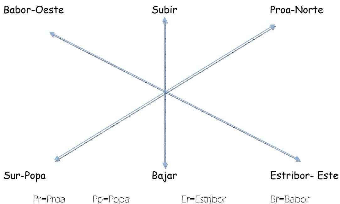
De este modo, según la situación de los mamparos (paredes del barco), esloras, cuadernas, tanques, etc. se dice que la tubería “**mira**” a proa, a popa, a estribor, etc.
