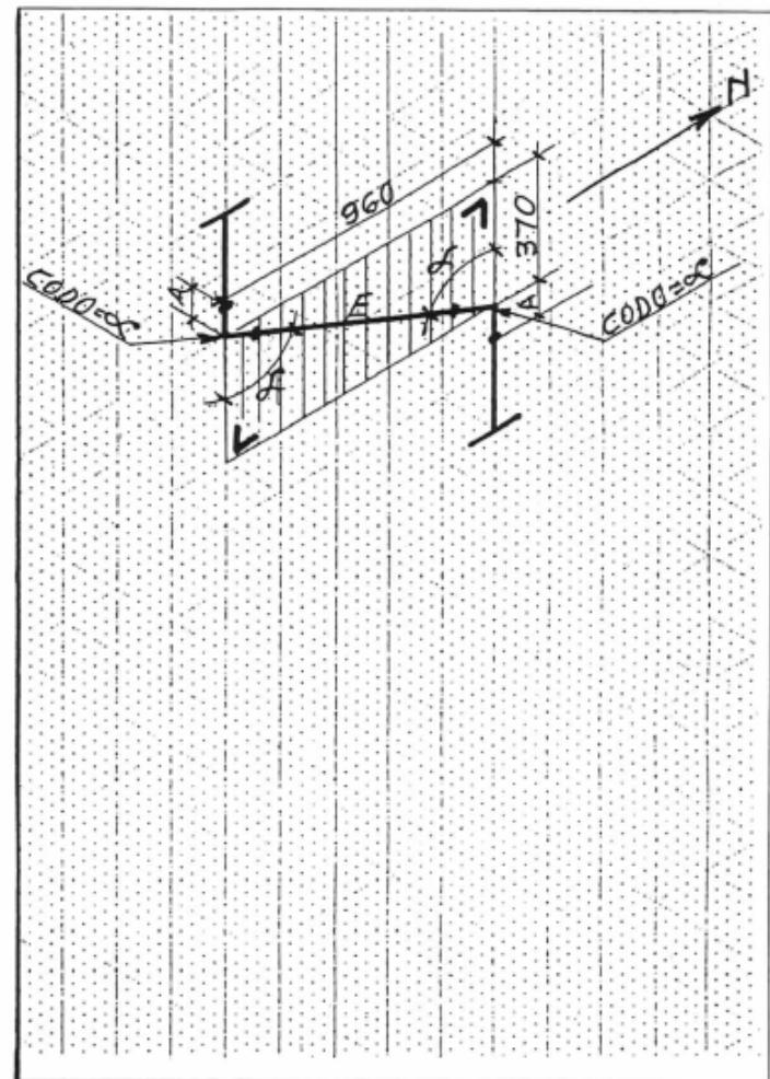
A continuación, comenzaremos a realizar cálculos de tubería situada en el cubo isométrico y nos auxiliaremos de pantallas al objeto de establecer los ángulos de los codos. Es muy importante saber elegir el plano inclinado que mejor se adapte a la interpretación y posterior resolución de cada ejercicio.
