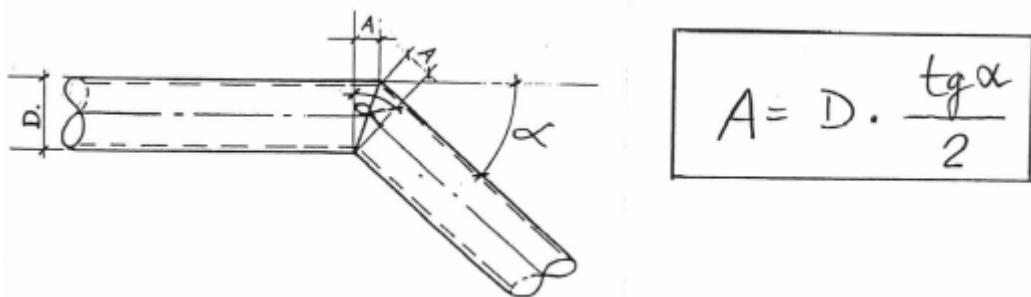
Es bastante común, confundir radio y diámetro y aplicarlos de forma equivocada en la fórmula anterior a la hora de realizar el cálculo de un codo, ya que estos pueden ser suministrados de forma comercial y no siendo éste el caso, lo obtendremos a partir del propio tubo.
