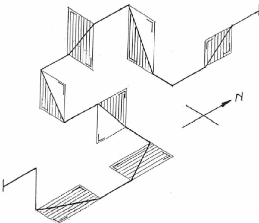
En el estudio de los planos auxiliares sobre los que se asientan los tramos de tubería y los codos que unen los mismos, vamos a ver unas láminas de modelos resueltos, para posteriormente realizar ejercicios en los que falta rayar dichos planos auxiliares necesarios para el establecimiento del ángulo del codo.
