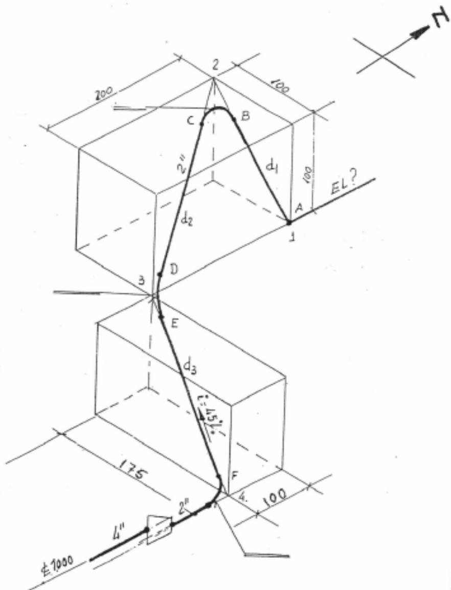
A continuación y utilizando las fórmulas aplicadas en el teorema del coseno resolvemos el ejercicio. Tal y como se aprecia, la tubería pasa de 4" a 2"; por tanto el diámetro exterior será de 60,3, correspondiéndole un radio de 76mm.
