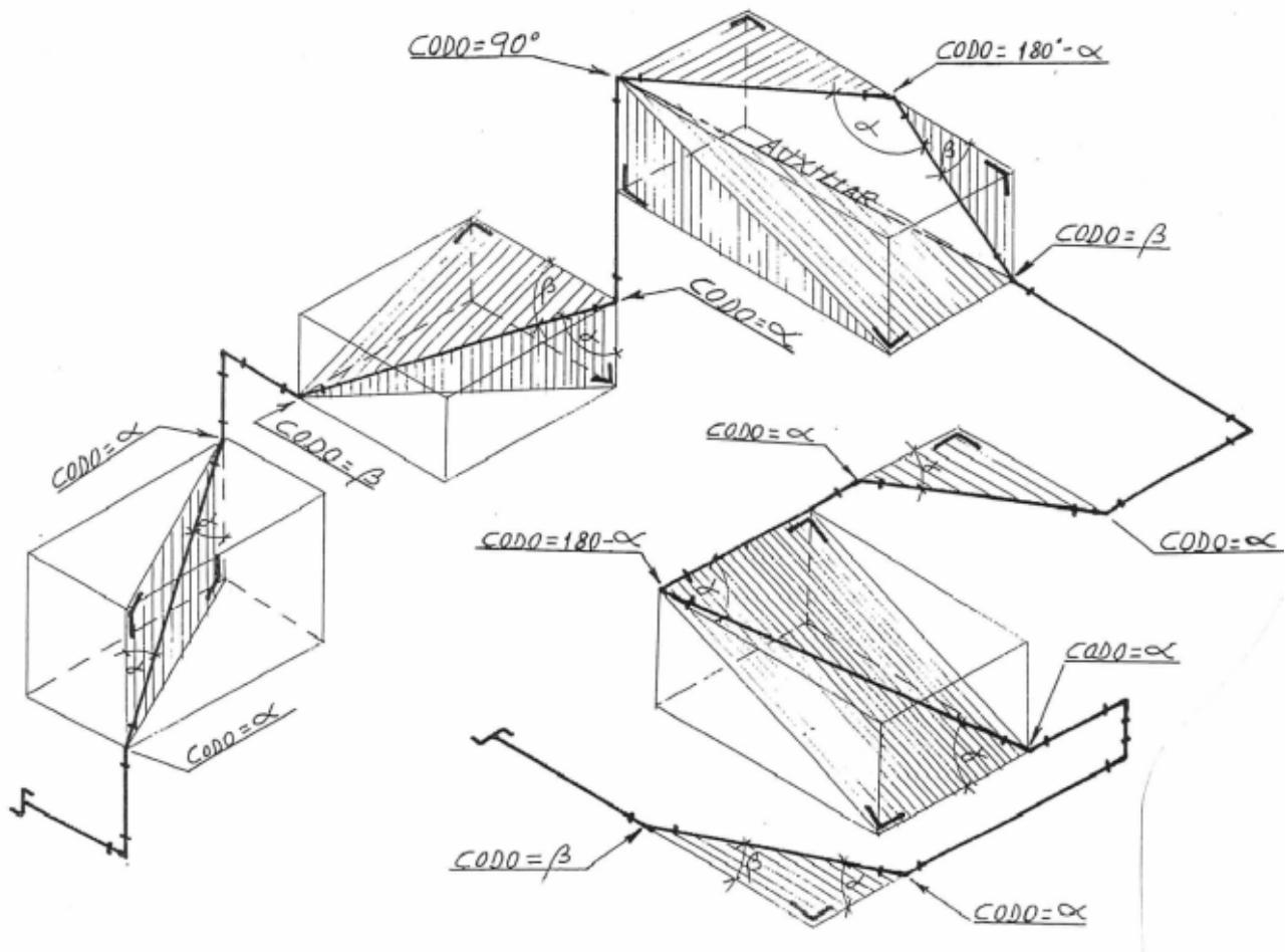
En este caso, para resolverlo es necesario saber calcular la auxiliar que aparece en la parte superior y para ello recurriremos a la aplicación de otro tipo de triángulos.
