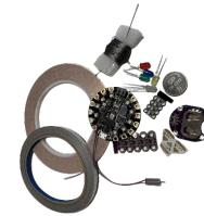
Los softcircuits son circuitos que se construyen con materiales flexibles, suaves o blandos, pueden ser: e-textiles, paper circuits, e-ceramics...
