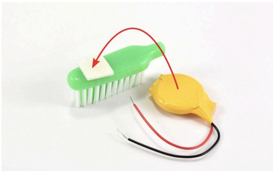
5 Conecta el motor al otro lado del cabezal del cepillo de dientes, de modo que los cables del motor se extiendan hacia la parte posterior de la cabeza del cepillo de dientes
