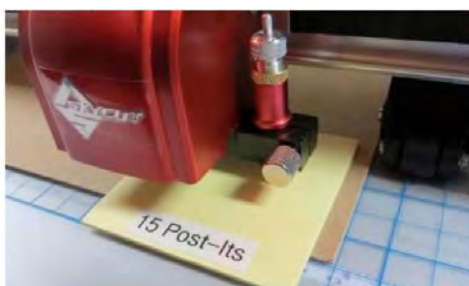
Utilice 15 con folla azul e para materiais lixeiramente máis grosos
