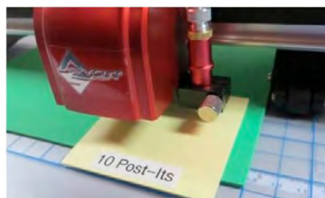
Usa 10 para materiais grosos como espuma artesanal e balsa
