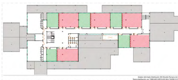
Fig. 29 Estado transformado. Creación de dúas aulas de diferente dimensión
