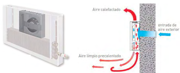
Fig. 11 Sistema de radiadores de admisión de aire para ventilación mecánica a través dos radiadores.
