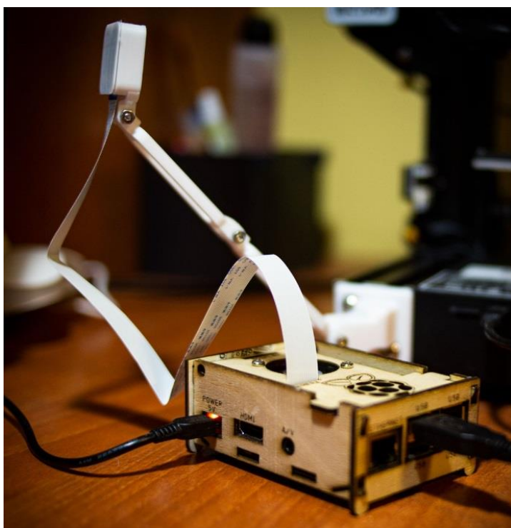
Carcasa de Raspberry pi cortada en madeira contrachapada de 3 mm
