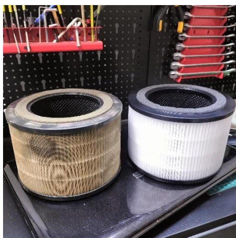
Filtro con 20 horas de uso xunto con un filtro novo.
