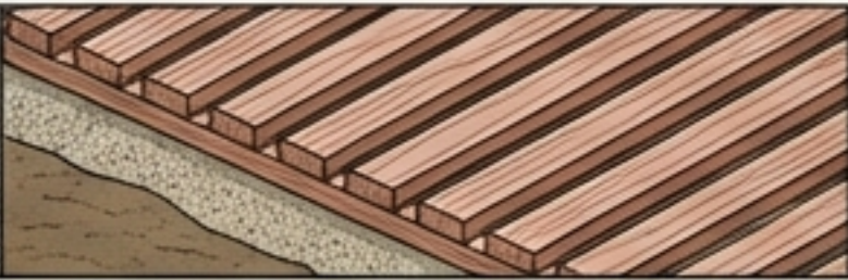
ENREJILLADO (SLATS): PASO DE DEYECCIONES (PORCINO)
