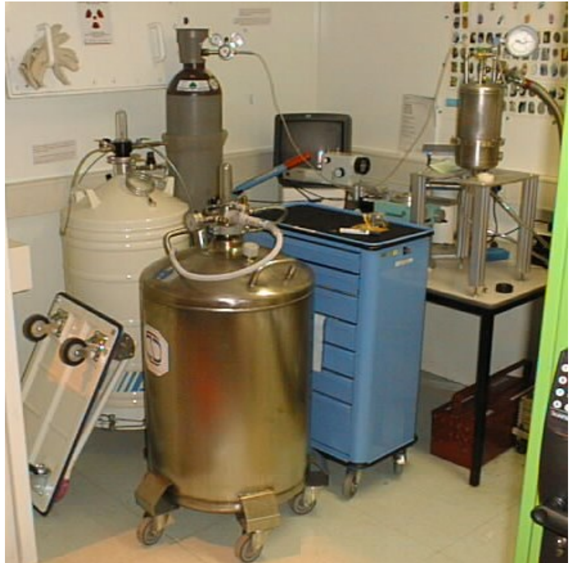
TANQUE DE NITRÓXENO LÍQUIDO
